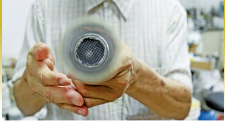
電觸媒蜂巢為一全新的促進氮氧化物分解(PND)技術的裝置
